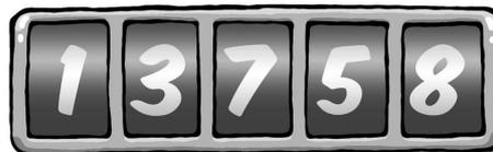
Das rechte Rad zählt die einzelnen Kilometer. Wenn es eine 8 anzeigt, dann sind dies 8 Kilometer. Das Rad links davon zeigt jeweils die vollen zehn Kilometer an: eine 5 bedeutet 50 Kilometer. Dann folgen die Hunderter: steht dort 7, dann bedeutet dies 700 Kilometer.
